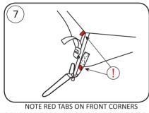
HOOK BUCKLE AROUND CORD AND PULL TO TIGHTEN
