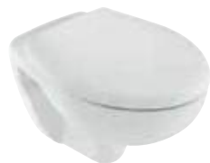
NF E4345-00 Brive - Cuvette suspendue 52 x 36 cm. Fonctionnement basse consommation double chasse 2,6/4 L ou 3/6 L.
