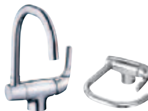
Natéo - Bec rabattable NF Mitigeur évier avec bec tube rabattable Ø 22 mm Limiteur de débit sensitif Aérateur anticalcaire Hauteur 295 mm (bec et levier rabattus 85 mm), saillie 205 mm E76250-CP - 306 € TTC
