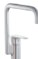
July NF Mitigeur évier. Bec tube orientable. Limiteur de débit sensitif. Aérateur anticalcaire Hauteur 277 mm, saillie 221 mm Débit 10 l/mn E5243-CP - 113 € TTC E98325-CP avec cartouche C3 à économie d'eau et d'énergie (levier centré = eau froide) 113 € TTC
