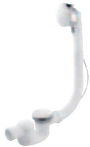
VIDAGE EXTRAPLAT Avec trop-plein réglable. Permet d'augmenter le niveau d'eau de 5 cm pour une profonde immersion. Câble 56 cm Compatible avec toutes nos baignoires sauf Evok, Capsule et Odéon Rive Gauche 180x85 cm E6D015-CP Chrome - 132 € TTC E6D015-00 Blanc - 132 € TTC En option : pieds raccourcis pour vidage E6D015 permettant de réduire la hauteur de la baignoire de 4 cm RWA621NF - 18 € TTC
