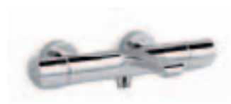
Thermostatique Bain-Douche mural Inverseur intégré dans la poignée de débit Butée de sécurité à 38° C Température maxi inférieure à 50° C Corps tiède. Débit 23 l/mn E97386-CP - À partir de 574 € TTC
