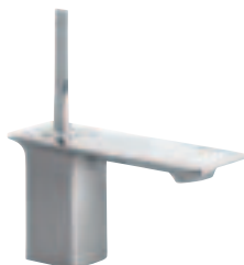
Mitigeur Lavabo Débit limité à 5 l/mn Aérateur anticalcaire intégré Sans tirette Bonde de vidage manuelle «Click» Hauteur 215 mm saillie 136 mm E14760-CP - 468 € TTC
