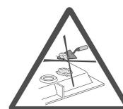
Le contact direct de produits à prise hydraulique avec la sous-face du receveur autres que mortier maigre est à proscrire. Il ne doit pas y avoir de blocage vertical ni latéral du receveur.
