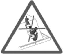
La baignoire ne doit subir aucune modification (sciage, meulage de renfort, déplacement de pompe...) autre que le perçage pour robinetterie ou poignées.
