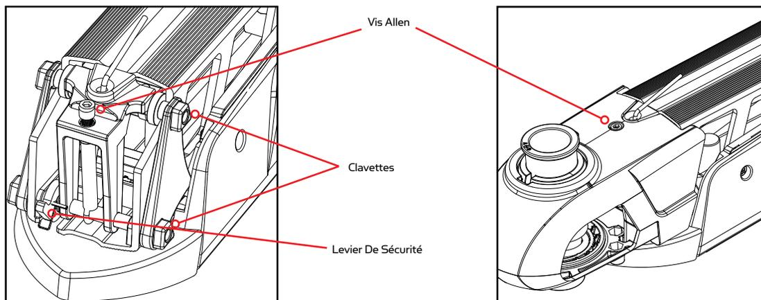
3. Alignez la rainure à l'intérieur du protège pouce par rapport aux maillons en bout du montant. Abaissez l'assemblage du moteur tout droit pour l'asseoir.
