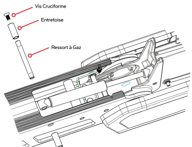
**AVERTISSEMENT: Les pièces mobiles peuvent écraser ou couper. Le mécanisme de levage assisté est sous pression. Débranchez le ressort au pas du gaz avant d'enlever le moteur du montant. Ne tirez pas la corde sans tout d'abord avoir décroché le ressort au pas du gaz.**
