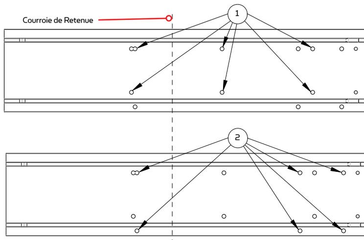
5. Montez la plaque sur la proue par les trous percés au moyen des boulons de 1/4-20 x 8,89 cm (3-1/2 po), écrous et rondelles fournis.
