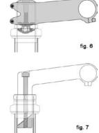
WARNING: A QUILL STEM'S MINIMUM INSERTION MARK MUST NOT BE VISIBLE ABOVE THE TOP OF THE HEADSET. IF THE STEM IS EXTENDED BEYOND THE MINIMUM INSERTION MARK THE STEM MAY BREAK OR DAMAGE THE FORK'S STEERER TUBE, WHICH COULD CAUSE YOU TO LOSE CONTROL AND FALL.
