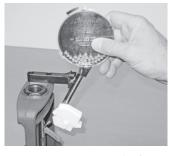
RE-ATTACH primer feed into primer feed bracket
