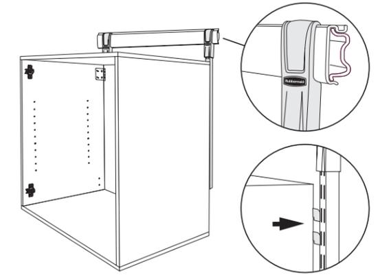
El gancho superior debe insertarse en la segunda ranura abierta a partir de la pinza de la hilera interior de ranuras.
