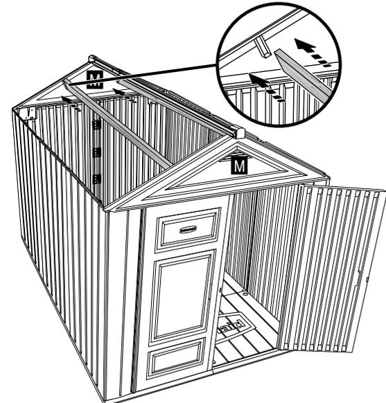
NOTA: se recomienda para zonas de mucha nieve o mucho calor. El uso del apoyo de madera es opcional. El cobertizo Big Max está diseñado para funcionar correctamente sin estas piezas; sin embargo, la madera brinda un apoyo extra del tejado en condiciones extremas.
