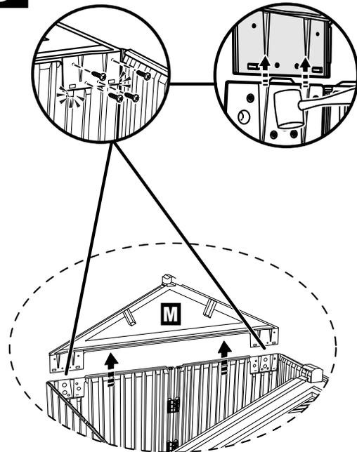
**9** Utilice un mazo de caucho para quitar los conectores (Q) de la pared en los cuatro puntos que unen el panel posterior izquierdo (E) y el panel posterior derecho (G).
