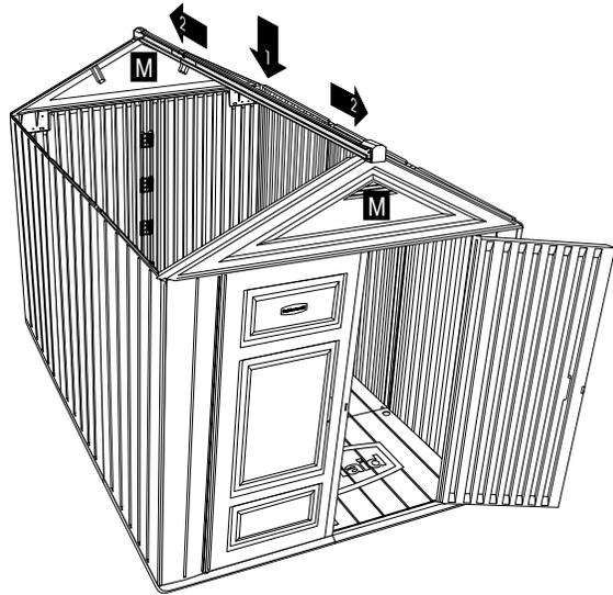
**26** Utilisez les pièces de la remise originale. Alignez les fentes de l'assemblage de la poutre de faîte avec les trous de la languette du pignon (M), puis installez un boulon (BB), une rondelle (CC) et un écrou (DD), EN SERRANT UNIQUEMENT AVEC LES DOIGTS.
