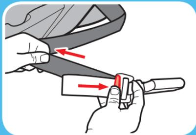
**4. Pase la correa del LATCH por la vía del cinturón orientada hacia atrás marcada con una etiqueta esbozada de azul**
