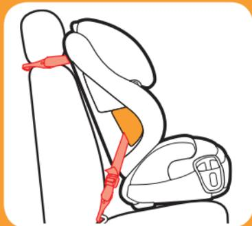
**Correa Correa del LATCH con el anclaje de sujeción superior**
