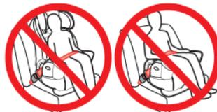
modo asiento elevado con un cinturón de seguridad del vehículo solamente para la falda
