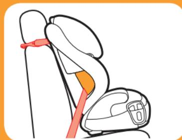
***Cinturón de seguridad del vehículo para la falda***
