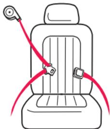
**Cinturón de seguridad para la falda y el hombro** Tres puntos de conexión. Se puede usar en todos los modos de uso del asiento de automóvil.
