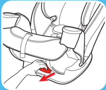
**3. Asegúrese que la correa del LATCH esté en la vía del cinturón orientada hacia atrás marcado con una etiqueta azul**
