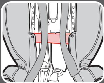
**Orientado hacia adelante:** Asegúrese de que el cinturón de seguridad de la aeronave pase detrás de la correa del arnés, que esté plano y sin doblarse.
