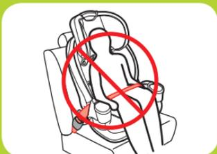
**Nunca use el cinturón de seguridad del vehículo solamente para la falda a través del frente del niño.**
