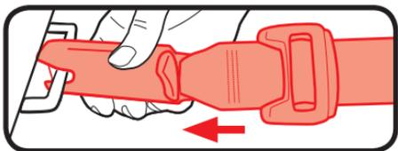
**13. Sujete los conectores del LATCH InRight™ a los anclajes inferiores del LATCH del vehículo**
