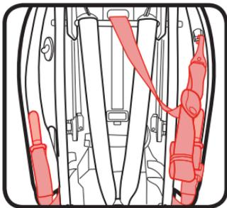
Graco permite sujetar el asiento de automóvil con el sistema de LATCH en el modo elevado. El niño **DEBE ESTAR SUJETADO** con el cinturón de seguridad del vehículo para el hombro y la falda. Se puede usar el LATCH en el modo elevado independientemente del peso del niño hasta las 100 libras (45 kg).
