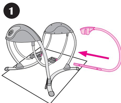
Insert the hanger tube with the six-sided holes into the swing arm bracket as shown. Ponga el tubo del colgante en los agujeros de seis costados en el soporte del brazo del columpio como se indica.
