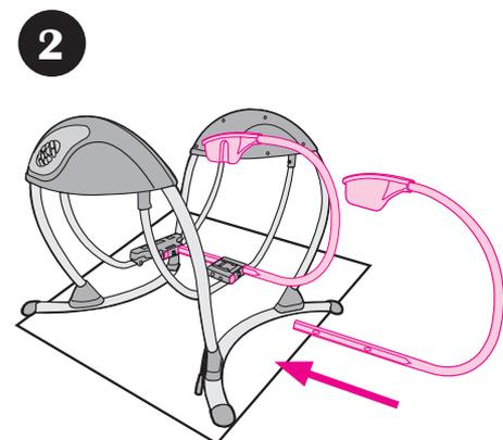
Insert the hanger tube with the oval-shaped holes into the swing arm bracket as shown. Ponga el tubo del colgante con los agujeros ovalados en el soporte del brazo del columpio como se indica.
