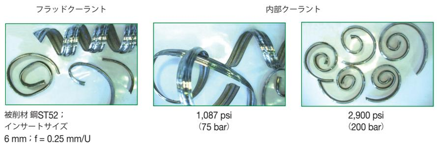
**圧力が低い** — 低クーラント圧により性能が不安定になる場合は、外部クーラントと内部クーラントを組み合わせることで供給量を増やします。
