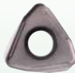
8 mm iC Wendeschneidplatte WOEJ0804 Bis zu 1,3 mm Ap max. Durchmesserbereich 25–80 mm
