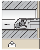
Stahlschaft mit innerer Kühlmittelzuführung.
