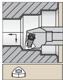
Stahlschaft mit innerer Kühlmittelzuführung.
