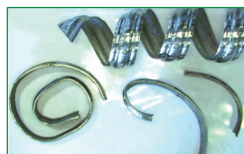
Materiál ocel ST52; Velikost břitové destičky 6mm; f = 0,25 mm/ot.
