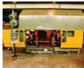
Simmons-Farrel CNC Portal-Radsatzdrehmaschine
