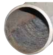
硬面堆焊的弯头
