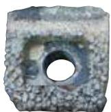
**KenCast-Schredderhammerspitze nach 40 Betriebsstunden** in hochabrasiver Recyclinganwendung von Asphaltchindeln. Beachten Sie, dass die hervorstehenden Hartmetallpartikel nur einen moderaten Verschleiß aufweisen. Diese spezielle Hammerspitze hat insgesamt 90 Stunden lang weiter gearbeitet und hält somit **bis zu 10 mal länger** als vergleichbare Werkzeuge!
