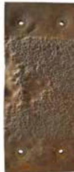
Gebrauchte Verschleißplatte mit minimalem Verschleiß nach 74.000 Tonnen
