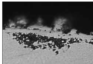
源自放电加工表面的腐蚀
