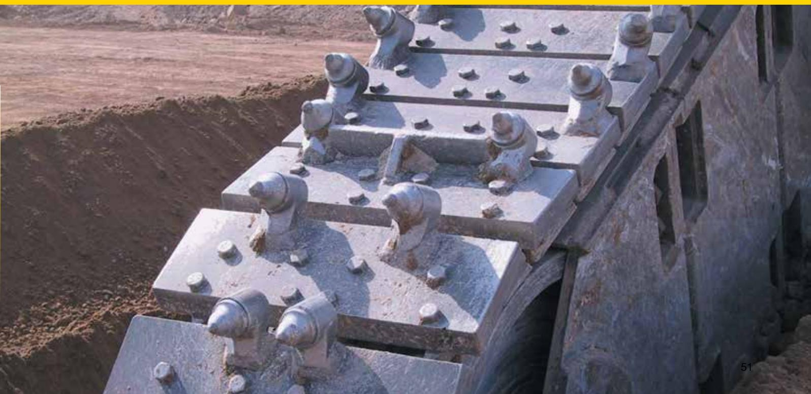
Système 38/30mm • Trancheuse à chaîne, Roue à Godets & Mineurs de Surface
