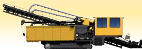
水平 定向钻孔装置
