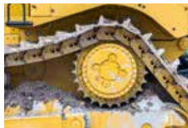
ERHÖHTES KETTENRAD, EINFACHE REINIGUNG
