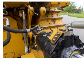
GROUPED MAINTENANCE POINTS
