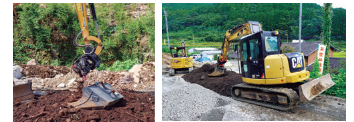
(左)左右40度のチルトと360度の旋回が可能なクイックカブラ (右)チルトローテータを装着した308E2 CR
