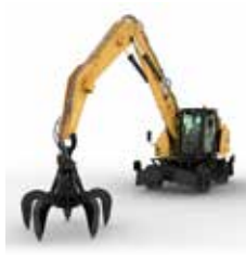
GRAAFMACHINES IN OVERSLAGUITVOERING
