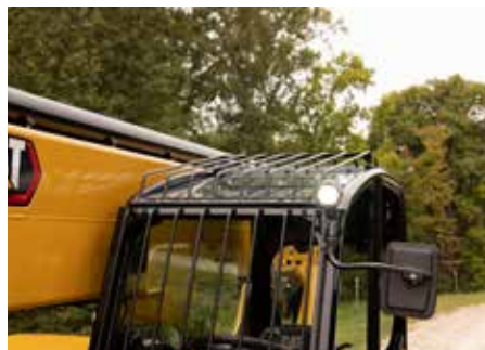
PROTECCIONES DE VENTANAS
