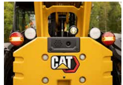
LUCES DE DESPLAZAMIENTO POR CARRETERA
