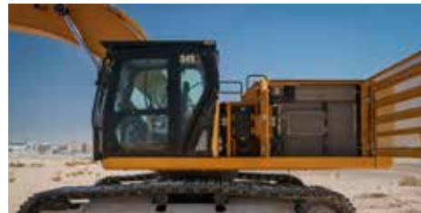
右侧维修平台
