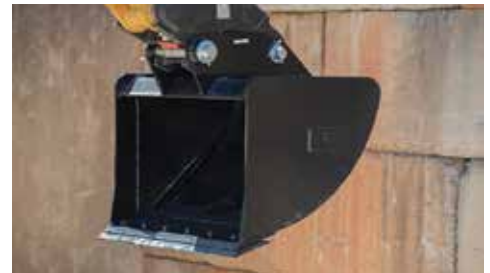
3 Tonnen Erdaushublöffel (Friedhof)
