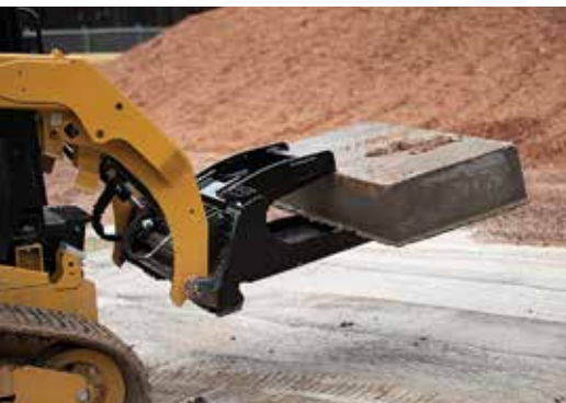
Godet de dalle de béton
