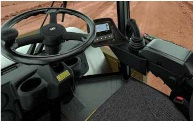
Stanowisko pracy operatora przedstawione z kabiną ROPS/FOPS i fotelem pokrytym tkaniną.
