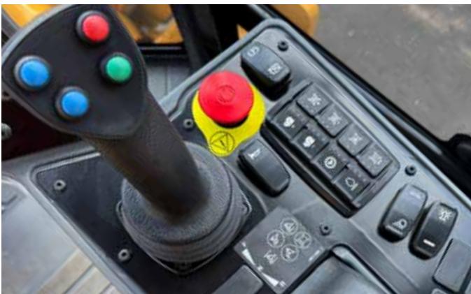
Dźwignia układu napędowego przedstawiona dla maszyn wyposażonych w opcjonalny lemięs wyrównujący.
