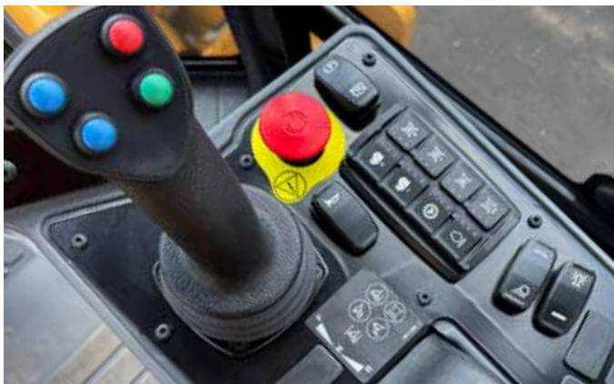
Рычаг хода показан для машин, оснащенных дополнительным планировочным отвалом.
