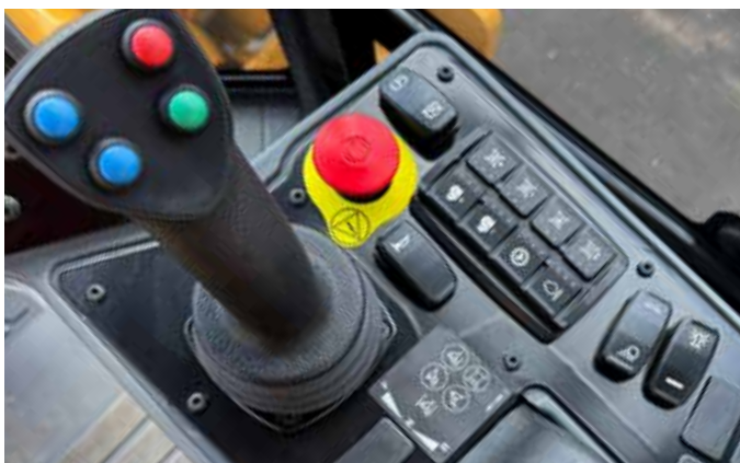
Illustration du levier de transmission pour les machines équipées de la lame de nivellement en option.
