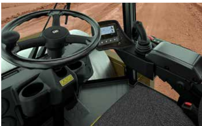
Compartmento do operador mostrado com cabine ROPS/FOPS e assento de tecido.
