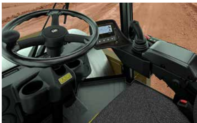
Illustration d'un poste de conduite avec cabine à cadre ROPS/FOPS et siège en tissu.
