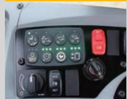
Catが業界で初めて採用したパワートレインと作業装置の応答性の設定機能は、運転席のキーパッドスイッチを使って簡単に、用途や好みに応じた応答性のカスタマイズが可能。他に必要に応じてリフトアームやバケットの操作性の設定や、前後進シフトの応答性も調整することができるので動作停止時や切り替え時のショックを軽減することも可能です。
