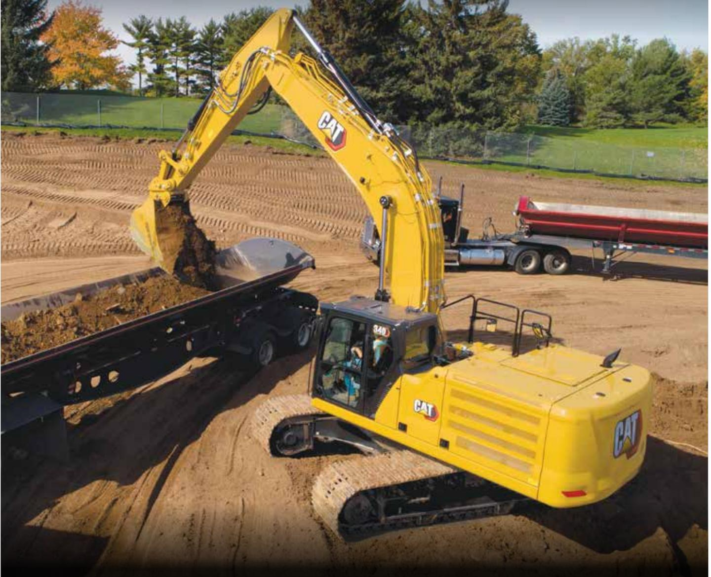
Cat Payload<sup>1</sup>는 적재 작업 중 실시간으로 중량을 계량하여 운전자가 정확한 적재 목표를 달성할 수 있게 함으로써 자재 과적재나 과소적재, 오적재를 방지합니다. Advanced Payload<sup>2</sup>는 맞춤형 태그, 일일 총량, 전자 티켓팅을 포함한 확장된 기능을 제공하는 계통 업그레이드입니다. Payload와 VisionLink<sup>®</sup>를 결합하면 작업 현장 및 각 자산을 분석하여 생산 목표와 주요 지표를 원격으로 관리할 수 있습니다.
