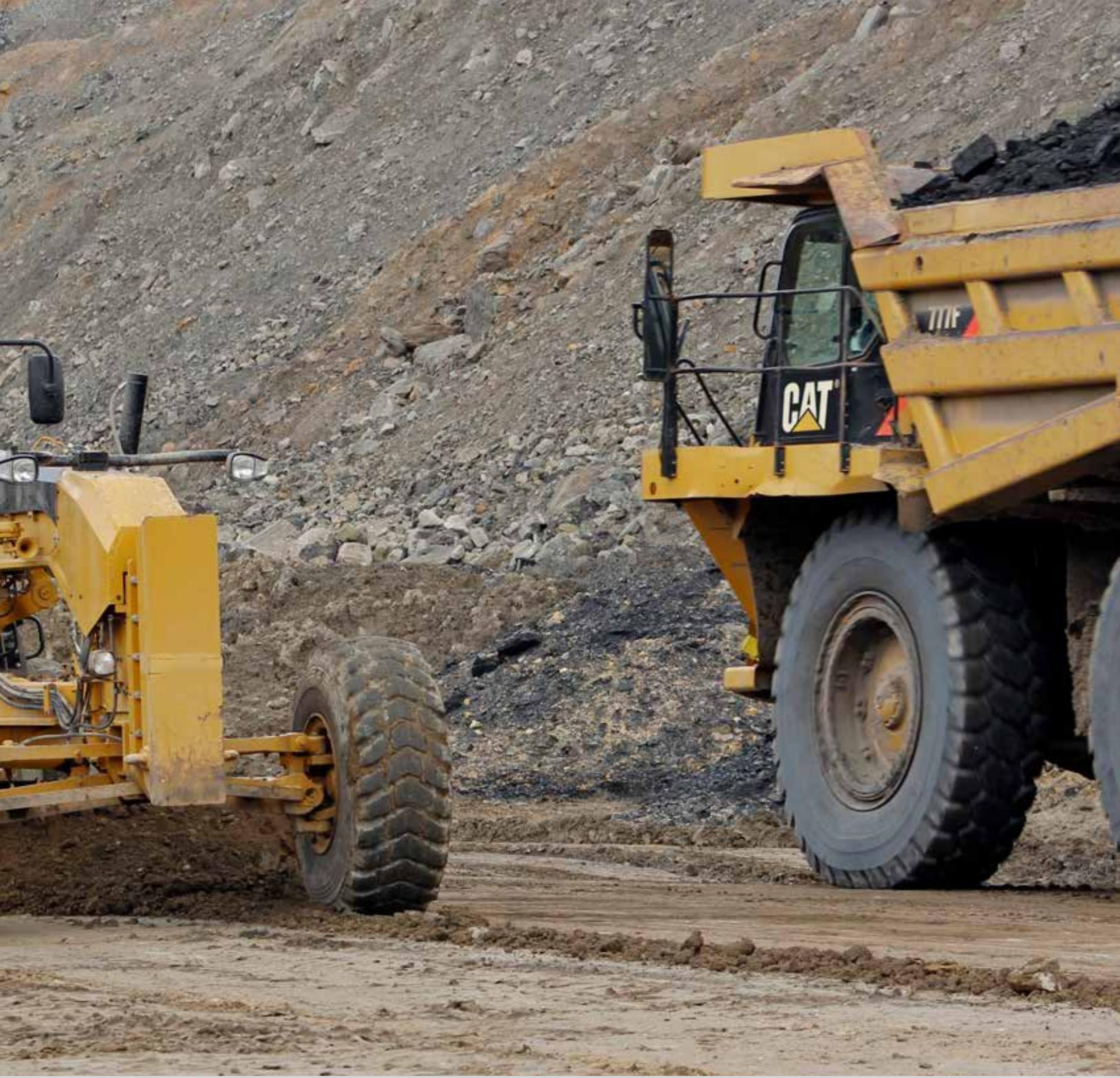
**Con potencia adicional, una vertedera más ancha y la posibilidad de utilizar un ángulo más agresivo de la hoja, la Motoniveladora 18 mejora la eficiencia de operación al aumentar la cobertura y reducir el número de pasadas necesarias para nivelar los caminos de acarreo.**
