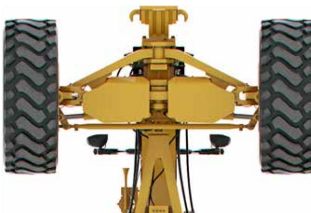
El cilindro de dirección del eje delantero se diseñó para mejorar la durabilidad. Además, se modificó el tendido de las mangueras hidráulicas para aumentar la fiabilidad.
