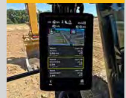
CAT PAYLOAD機能で、オペレータは車両で計量を行えるため、目標積載質量まで積み込むことができ、過積載や過少積載を防止します。オプションのAdvanced PAYLOADは、カスタムタグ、日次合計、電子チケット発行などの拡張機能を提供するシステムアップグレードです。PAYLOADとVisionLink<sup>®</sup> Productivityを組み合わせて、現場と個々の資産を分析し、生産目標と主要な指標をリモートで管理します。
