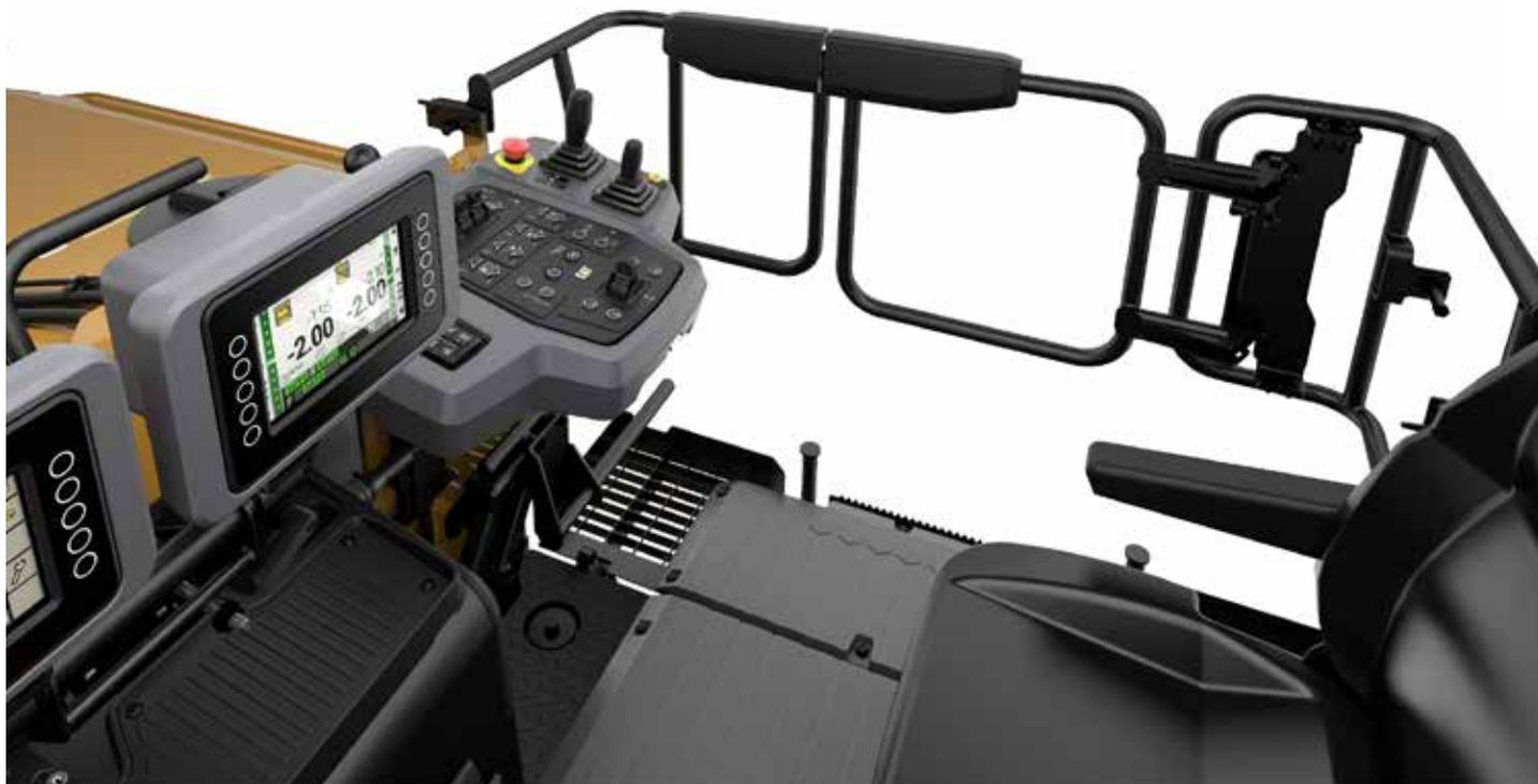
El área de trabajo puede configurarse según las preferencias del operador y la posición de trabajo. Las pantallas táctiles proporcionan acceso al grupo de medidores, la información de operación, las imágenes de la cámara remota, los controles de la máquina y los datos de diagnóstico.
