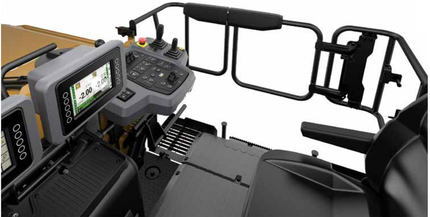
工作區域可設定駕駛員偏好設定和作業位置。觸控螢幕顯示器可存取儀表組、作業資訊、遠端攝影機訊號、機器控制及診斷。
