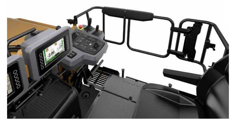
El área de trabajo puede configurarse según las preferencias del operador y la posición de trabajo. A través de las pantallas táctiles, se puede acceder al conjunto de indicadores, así como a información sobre el funcionamiento, las imágenes de las cámaras remotas, los controles de la máquina y los diagnósticos.
