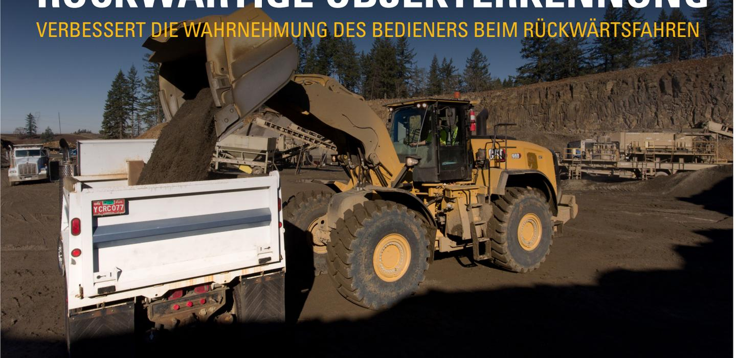
Die rückwärtige Objekterkennung für Radlader ist ein System für eine verbesserte Totwinkelkontrolle. Ein Radar warnt optisch und akustisch, wenn ein Objekt in den Sicherheitsbereich gelangt. Mithilfe der Kamera kann sich der Fahrer beim Rückwärtsfahren ein Bild vom Bereich hinter der Maschine machen.
