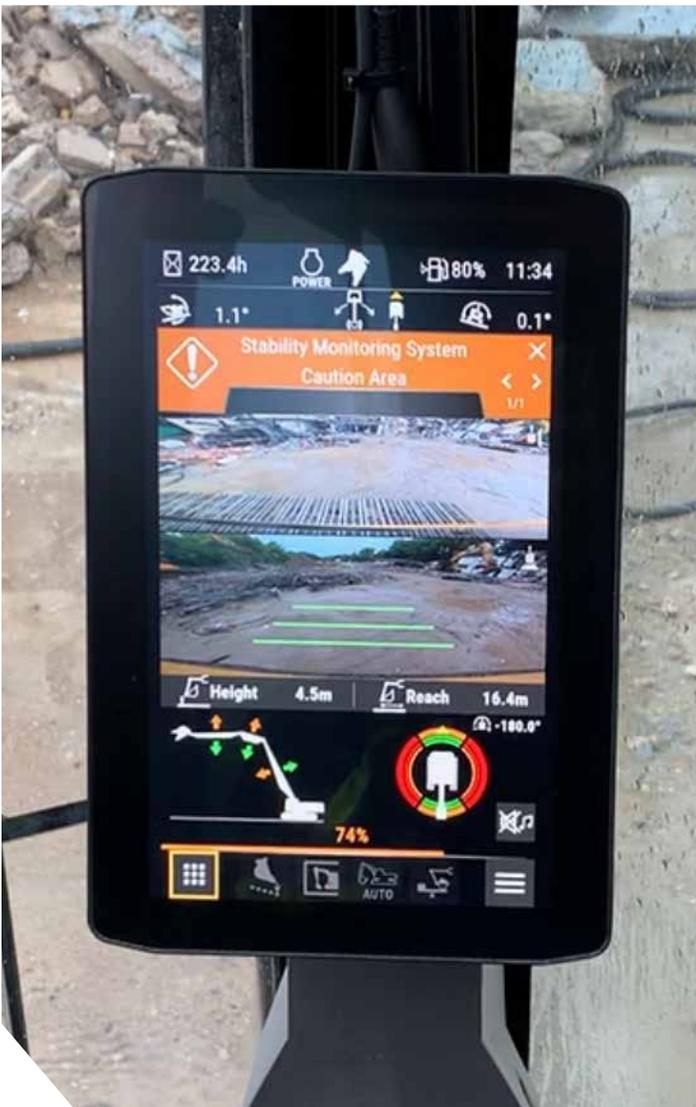
El sistema monitor de estabilidad Cat para las máquinas con pluma delantera de UHD le permite estar al tanto de la posición del accesorio dentro de la gama de trabajo segura. El sistema controla la posición de la parte delantera y el ángulo de giro. Los indicadores audibles y visuales advierten al operador cuando se acerca al límite de estabilidad.
