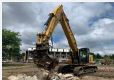
El sistema hidráulico auxiliar le proporciona versatilidad para usar una amplia gama de accesorios de demolición Cat, que incluyen martillos, cizallas, pulverizadores, garfios y más. El contrapeso garantiza la estabilidad incluso con los implementos más pesados.
