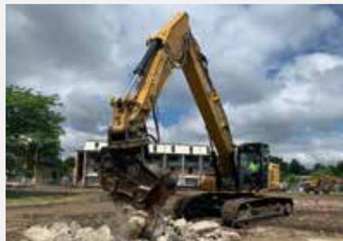
Die Zusatzhydraulikkreise bieten Ihnen die Vielseitigkeit, eine breite Palette an Cat-Abbrucharbaugeräten nutzen zu können, darunter Hämmer, Scheren, Pulverisierer, Greifer und mehr. Das Kontergewicht sorgt auch bei den schwersten Anbaugeräten für Stabilität.
