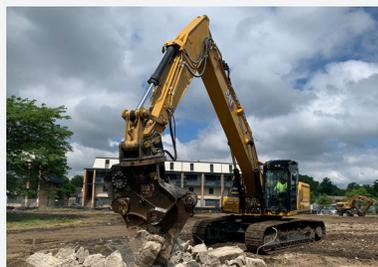
Les circuits hydrauliques auxiliaires vous offrent la polyvalence nécessaire pour utiliser une large gamme d'accessoires de démolition Cat, notamment des marteaux, des cisailles, des pulvérisateurs, des grappins et bien plus encore. Le contrepoids assure la stabilité même avec les accessoires les plus lourds.
