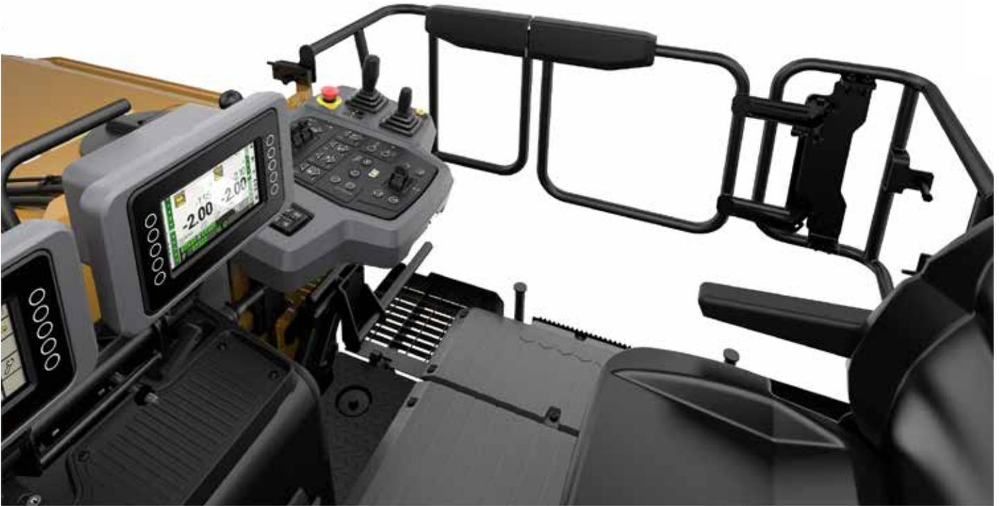
L'espace de travail peut être adapté en fonction des préférences et de la position de travail des conducteurs. L'écran tactile permet d'afficher le groupe d'instruments, les informations de fonctionnement, les flux des caméras à distance, les commandes de la machine et les diagnostics.
