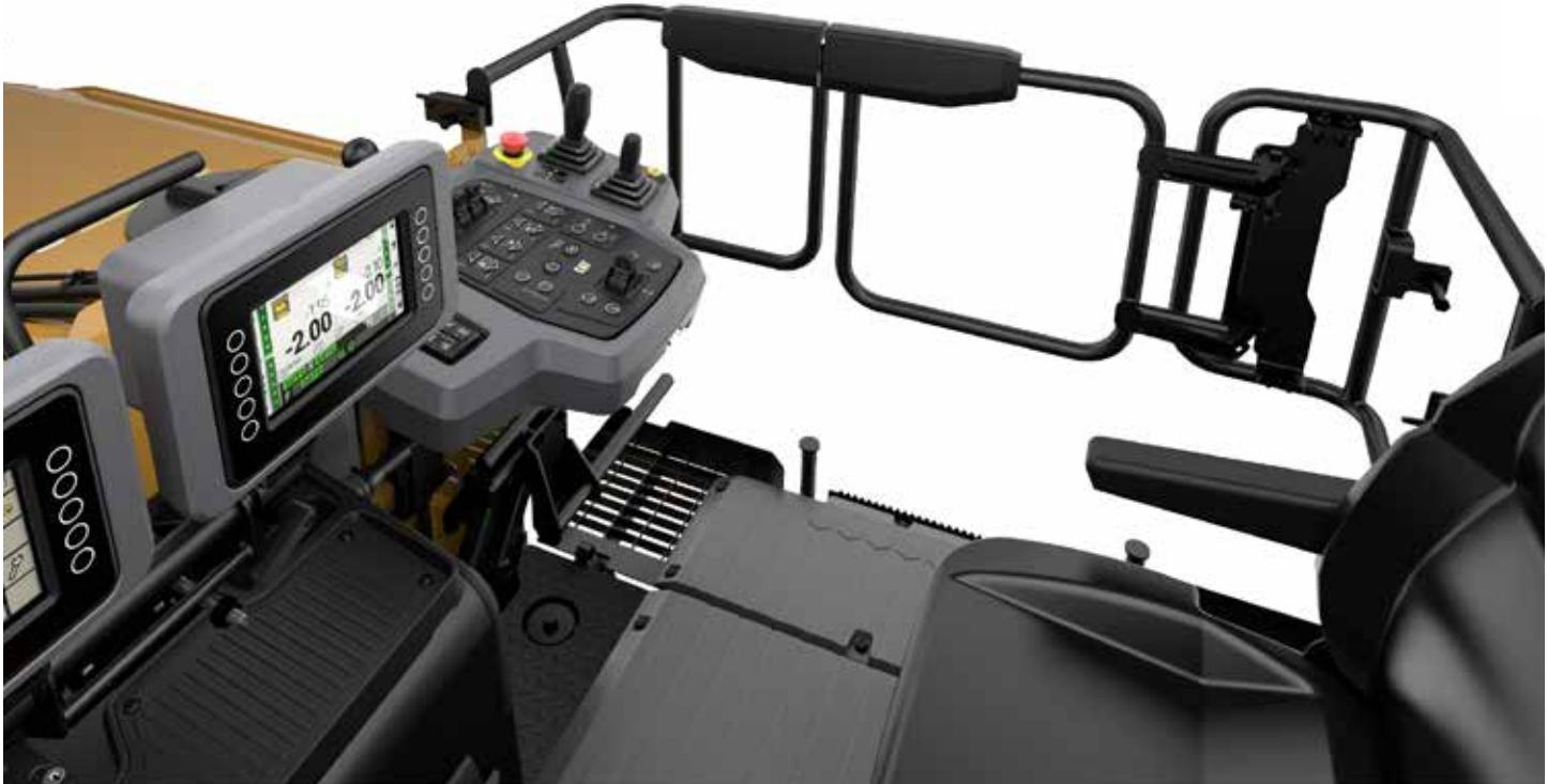
운전자의 기본 설정과 작업 위치에 따라 작업 영역을 설정할 수 있습니다. 터치스크린 표시장치를 통해 게이지 클러스터, 작동 정보, 원격 카메라 피드, 장비 제어장치 및 진단에 접근 가능
